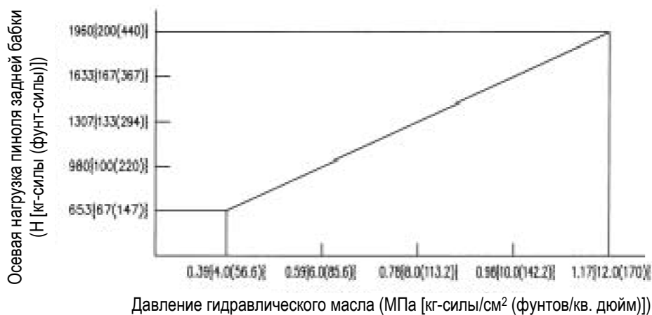
Рис. 3-15. Соотношение давления гидравлического масла и осевой нагрузки втулки задней бабки (ES-L6)
