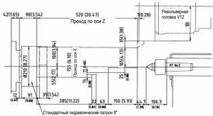
Рис. 7-21. Схема рабочего диапазона (для прямого резцедержателя)
