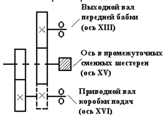
Рисунок 14 - Схема установки сменных шестерен
